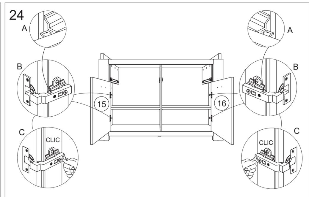
Voor de juiste regeling van de deuren moet U ervoor zorgen dat de kast goed waterpas staat, ook kunt U met de schroeven van de scharnieren 170 de deuren bijregelen. U kan ook de deuren vertikaal bijregelen. Ontspan vijzen A en schuif de scharnierblok nr. 171 naar onder of naar boven en schroef terug vast.
