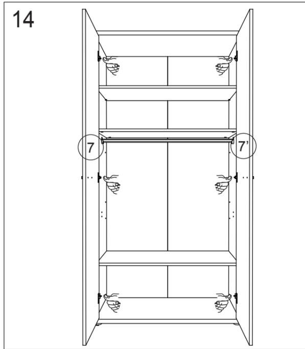
Voor de juiste regeling van de deuren moet U ervoor zorgen dat de kast goed waterpas staat, ook kunt U met de schroeven van de scharnieren 201 de deuren bijregelen. U kan ook de deuren vertikaal bijregelen. Ontspan vijzen A en schuif de scharnierblok nr. 203 naar onder of naar boven en schroef terug vast.
