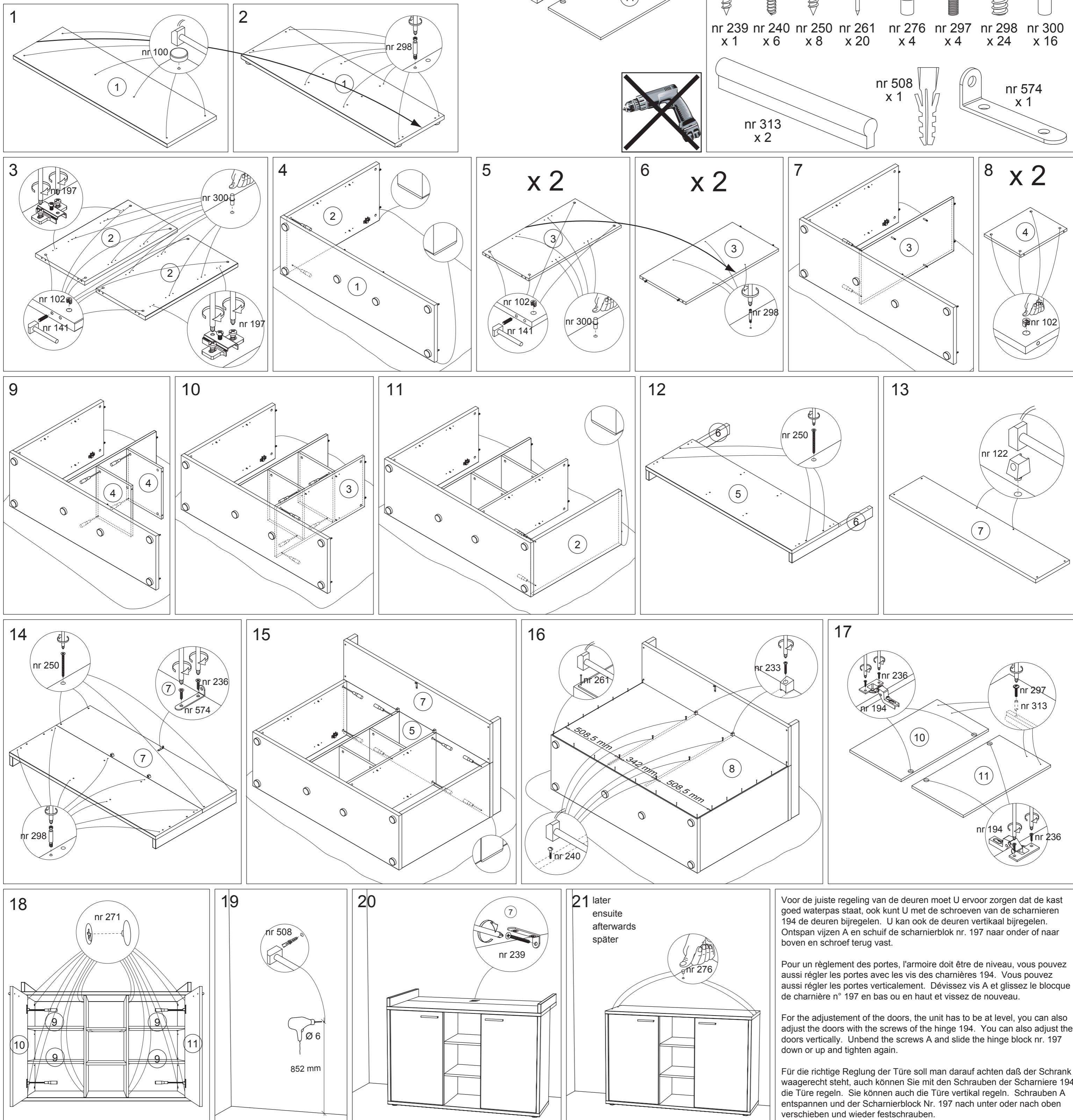
Voor de juiste regeling van de deuren moet U ervoor zorgen dat de kast goed waterpas staat, ook kunt U met de schroeven van de scharnieren 194 de deuren bijregelen. U kan ook de deuren verticaal bijregelen. Ontspan vijf A en schuif de scharnierblok nr. 197 naar onder of naar boven en schroef terug vast.
